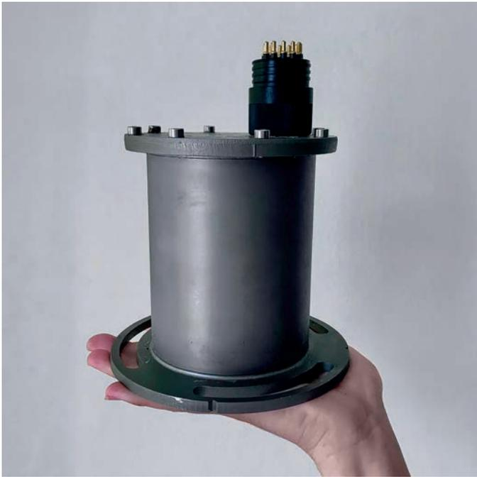
**Figura 9** – Sensor de Movimento SMC S-108 que foi utilizado nos dias do levantamento.
