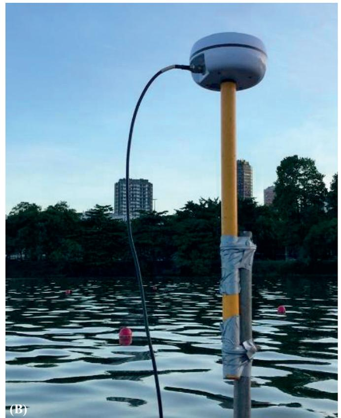
**Figura 8** – Antena DGPS Hemisphere R130 utilizada na aquisição de dados para os dados de ecobatímetro monofeixe e sonar de varredura lateral. (B) Antena DGPS montada fazendo a aquisição de dados.
